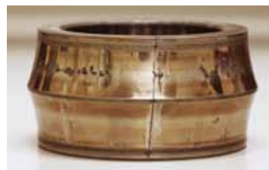
● Voorbeeld van een lager met een gebroken binnerring
