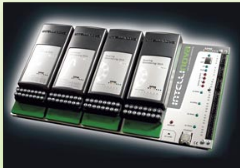
De Commander Unit biedt optimale flexibiliteit door toepassing van diverse soorten I/O modules.
