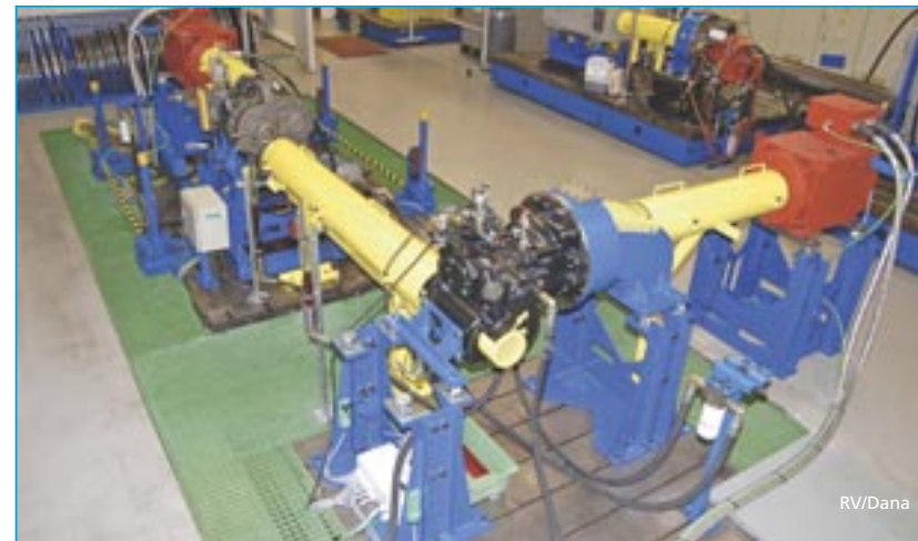
Via de testen wil men zeker zijn dat de schakelkast voldoet aan alle duurzaamheidsvereisten waaraan deze in haar latere levensloop zal onderworpen zijn (hier de Hertz-testopstelling).
