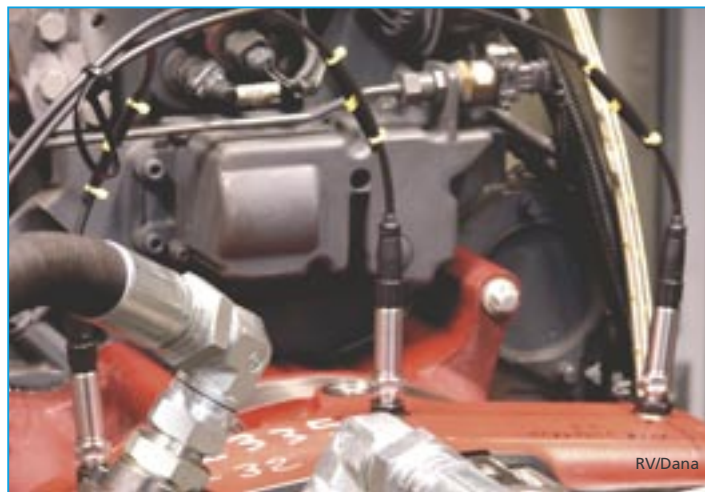
Spicer Off-Highway Drivetrain Products in Brugge zet SPM meetapparatuur in voor het bewaken van de transmissietesten.
